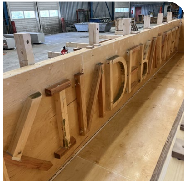
De houten mal met letters in spiegelbeeld wordt voorbereid voor productie.
